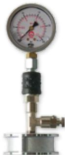
La Calotta UNI è da utilizzare per il rilevamento della pressione statica secondo la norma UNI 671/3. Realizzata in ottone cromato, è indispensabile per effettuare la manutenzione semestrale della rete idranti. La calotta è composta da un manometro in bagno di glicerina (0-25 Bar) e una valvola di sfiato. Disponibile in 3 modelli:
