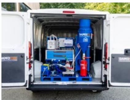
L'unità mobile SKID AC/FG8 raccoglie su un'unica piattaforma trasportabile tutte le apparecchiature indispensabili per la manutenzione e per il riempimento degli estintori a polvere ed a CO2, oltre agli accessori di servizio di un'officina mobile.
