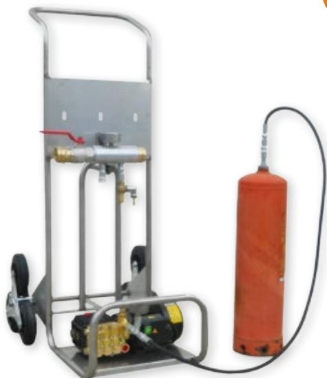
L'unità N7/1 FH-E consente di effettuare i collaudi idraulici dei serbatoi degli estintori a polvere e delle manichette antincendio. La pompa è facilmente trasportabile, in quanto installata su carrello in acciaio INOX, dalla specifica configurazione a tre ruote. Questa caratteristica, insieme alle dimensioni e al peso ridotto della pompa, fanno sì che essa sia anche particolarmente adatta per interventi diretti a domicilio cliente.
