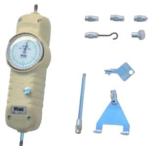
Il dinamometro meccanico è uno strumento portatile di precisione che lavora sia in trazione (per la verifica del peso degli estintori) che per compressione (per la verifica della forza richiesta per l'azionamento del maniglione antipánico) e mantiene il valore di picco applicato. Il dinamometro viene fornito con un set di accessori per le varie misure e il certificato di calibrazione emesso dal fabbricante.
